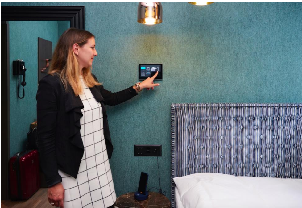
Bild 6: Im digitalSTROM-vernetzten Smart Room steuert der Gast über den Touchscreen Licht, Beschattung und Musik Download: http://bit.ly/digitale_Reise_6
